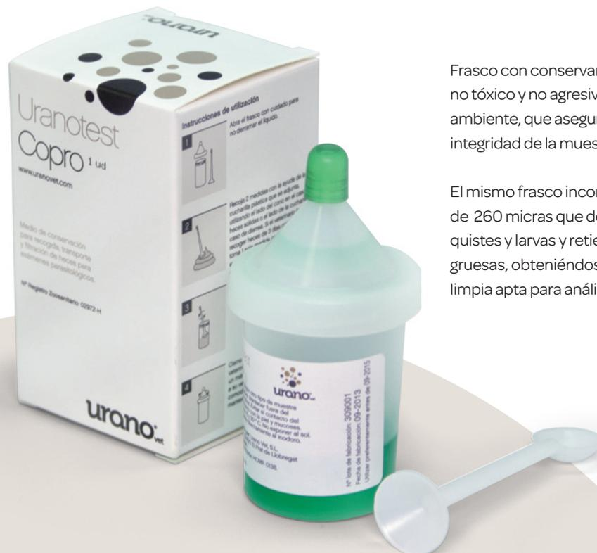
Frasco con conservante Greenfix<sup>®</sup>, no tóxico y no agresivo con el medio ambiente, que asegura la conservación e integridad de la muestra durante 15 días.
